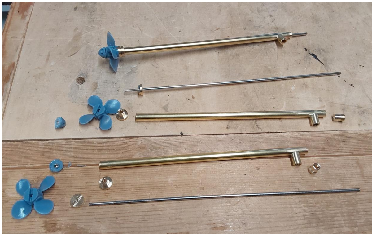
Akseliin leikatun M3 kierteen avulla potkurit lukittuvat hyvin paikoilleen.
