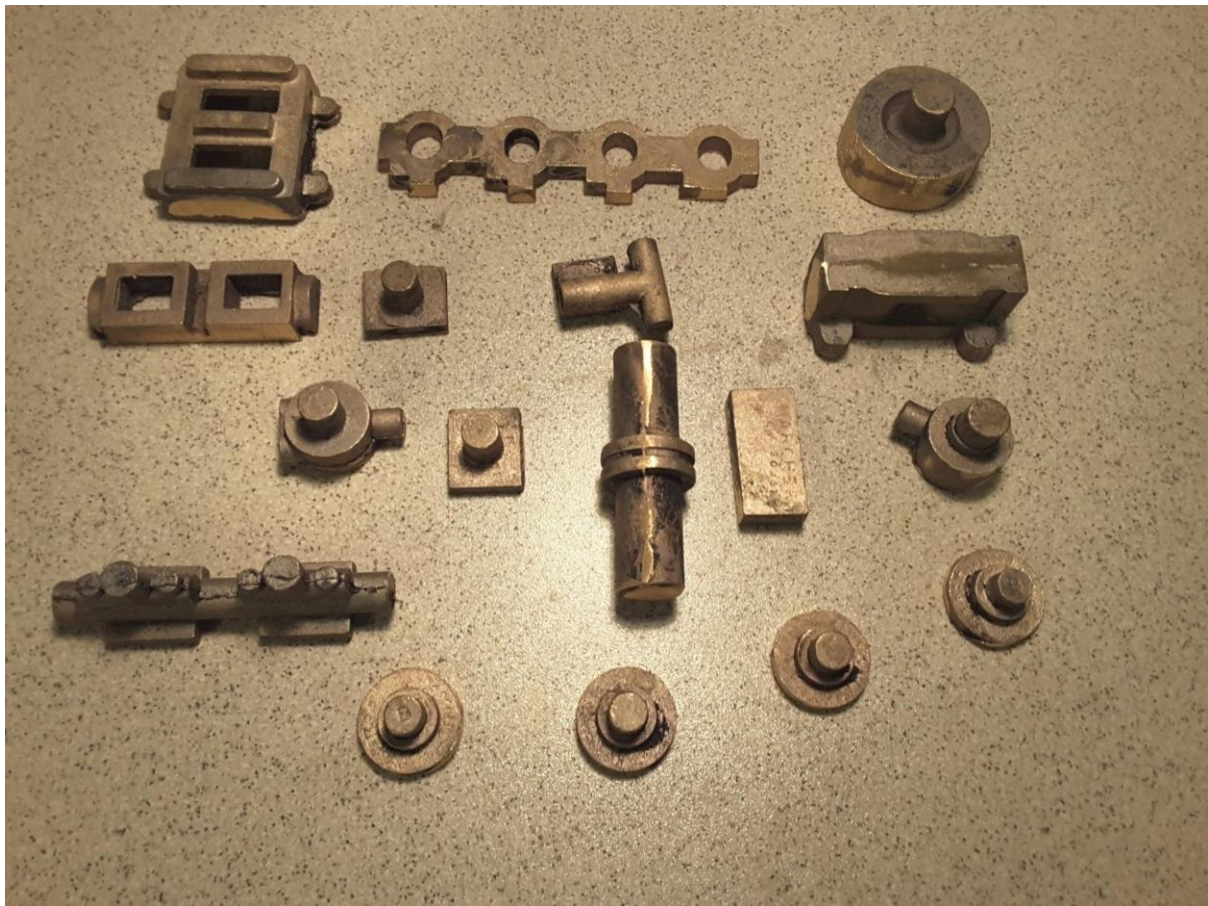
Marcher höyrykoneen valuosat. Ne ovat ns. gunmetal-materiaalia, eli jonkin sortin pronssia.
